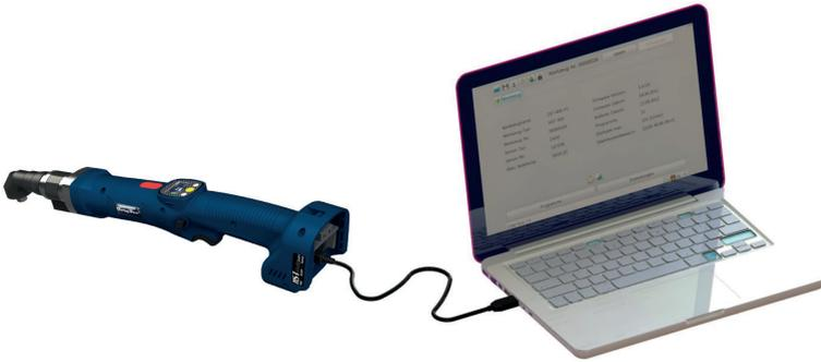
Starten sie den SmartTool-Manager, melden Sie sich an und lesen Sie das vorliegende Werkzeug aus in dem Sie auf „Lesen“ klicken. Nun können Sie wie in den nächsten Schritten beschrieben die Einstellungen des Werkzeugs bearbeiten. Damit die Werkzeugparametrierung nicht verloren geht, empfehlen wir diese separat unter einem anderen Namen zu sichern.
