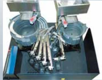
Jede Zuführbahn, Vereinzelung und Zulasleitung wird getrennt von Sensoren überwacht.
