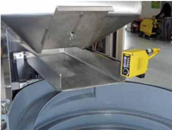
Der ebenfalls sensorgesteuerte Bunker garantiert eine gleichbleibende Füllmenge der Rüttlerschale.
