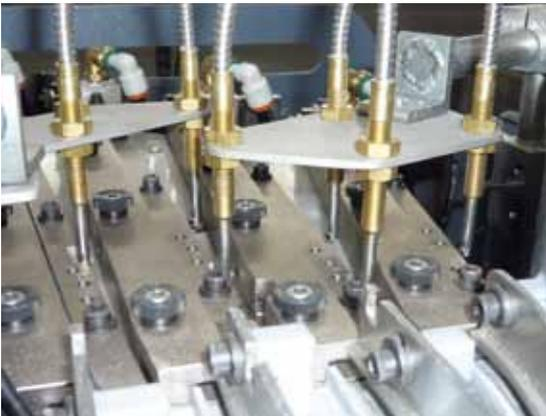
Sensoren überwachen und regulieren die Bevorratung der Muttern in den Zuführbahnen.
