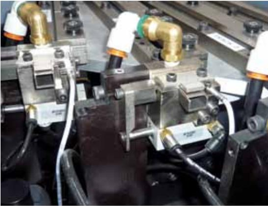
Jeweils eine Mutter wird über die sensorüberwachten Vereinzeler in das Werkzeug eingeblasen und verarbeitet.
