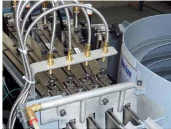
Sensoren überwachen und regulieren die Bevorratung der Bolzen in den Zuführbahnen.
