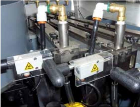
Jeweils ein Bolzen wird über die sensorüberwachten Vereinzeler in das Werkzeug zugeblasen und verarbeitet.
